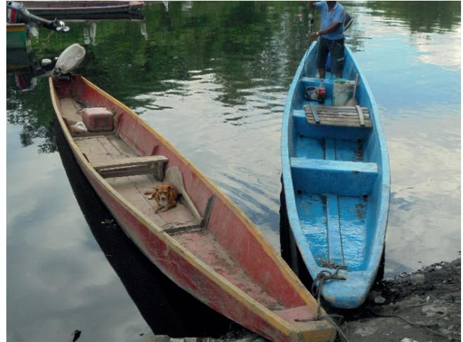
Figura 63. Bote de madera denominado "motor canoa" para la operación de redes tipo "mallón".
