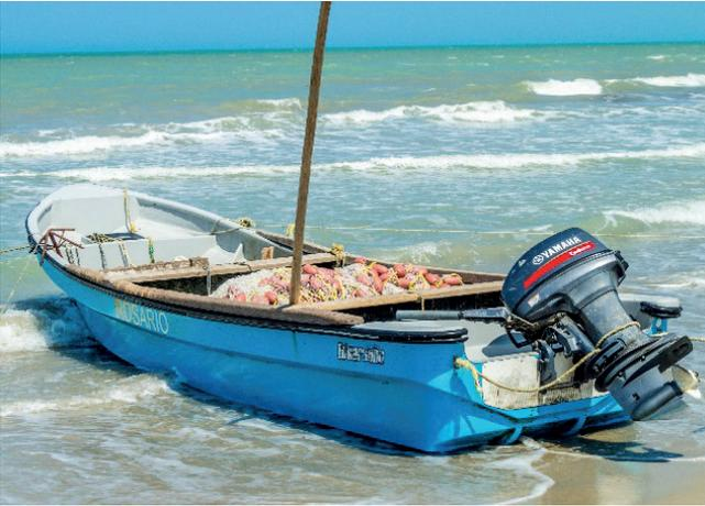
Figura 6. Lancha de fibra de vidrio para operar la red de enmalle fija o de "lanceo".
