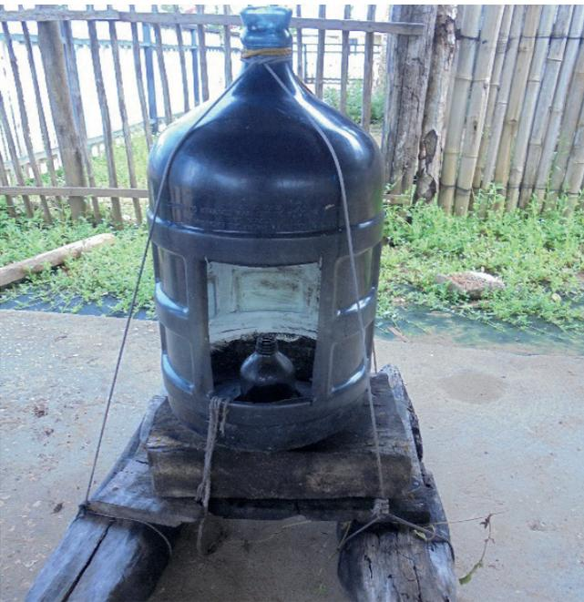
Figura 14. Mechón artesanal utilizado en los extremos de las redes caladas a fondo.
