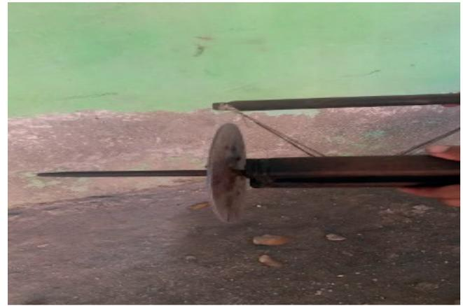
Figura 9. Dispositivo artesanal "carrucha" para torsionar hilos.
