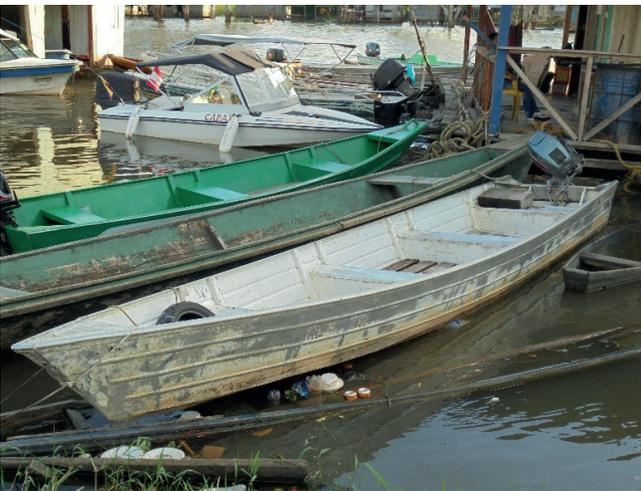
Figura 52. Embarcaciones tipo chalupa con casco de aluminio.
