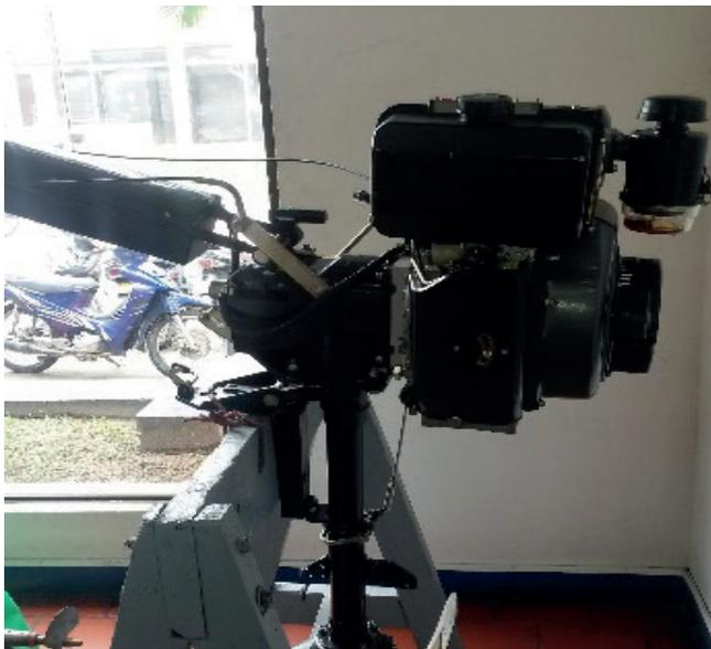
Figura 55. Motores fuera de borda diésel de 12 HP marca MIHEN.
