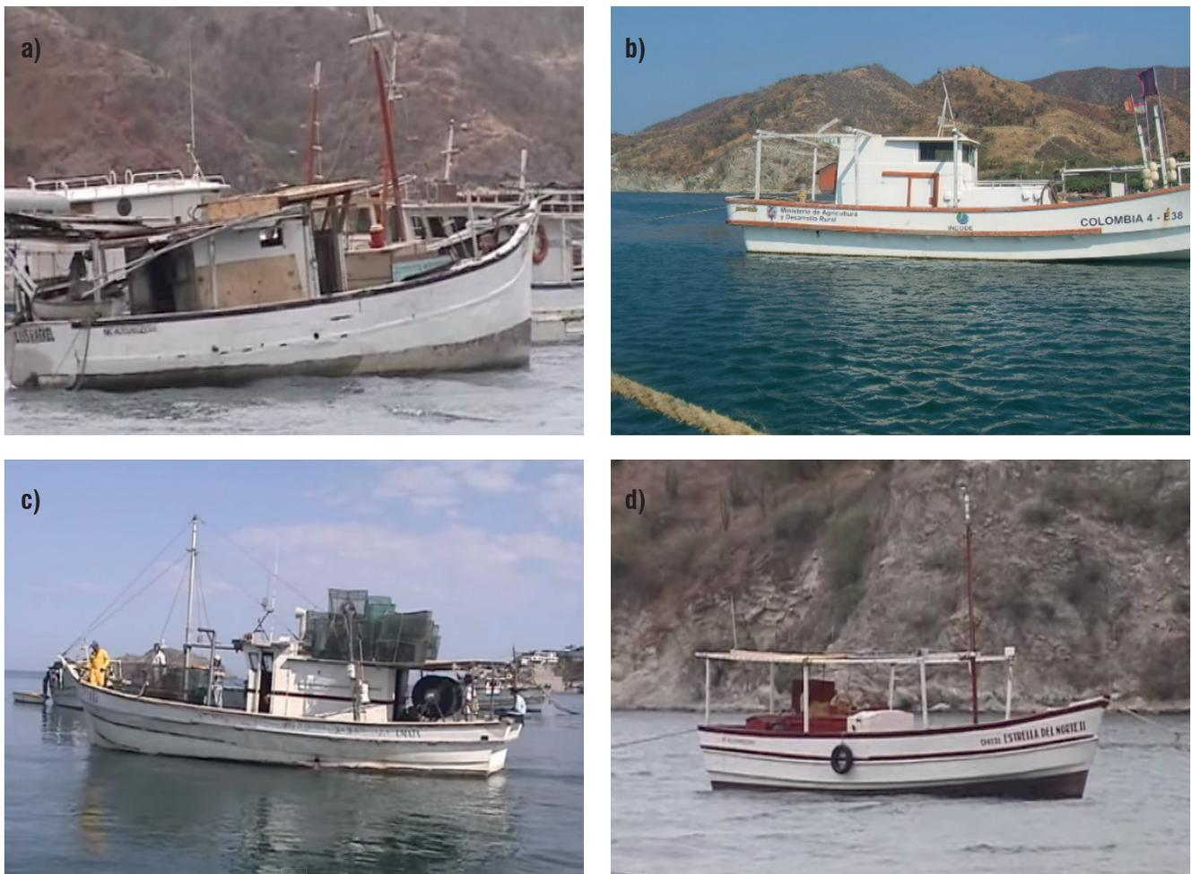
Figura 5. Embarcaciones pargueras típicas de Taganga, con cascos construidos en: a) madera recubierta en fibra de vidrio y b) fibra de vidrio, c) algunas pueden tener puente de mando cuyo techo sirve para el acarreo de nasas y d) otras envés de puente utilizan un toldo para protegerse del sol.
