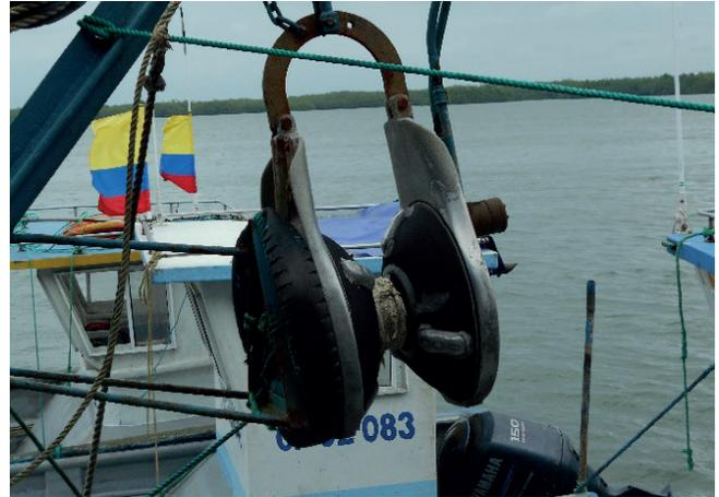
Figura 31. Polea “power block” para subir la red.
